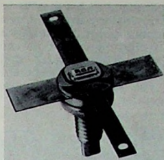
Bild 7. Bei 400 MHz liefert dieser Transistor 2N6104 rund 30 W bei 5 dB Leistungsgewinn (RCA)
