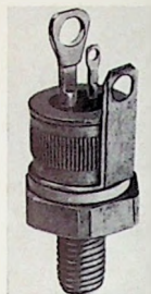
Bild 4. Thyristorgehäuse für Einpress- und Schraubbefestigung (RCA)
