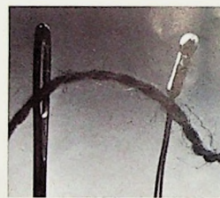
Bild 5. Heißeiterelement in Kleinstausführung (Siemens)
